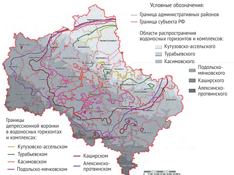
Рис. 20. Модельная схема распространения региональной депрессионной воронки в эксплуатируемых водоносных горизонтах и комплексах Московского региона (по данным мониторинга подземных вод АО «Центральное ПГО». М., 2014)
