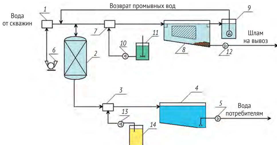
Рис. 22. Технологическая схема станции обезжелезивания подземных вод (1):
