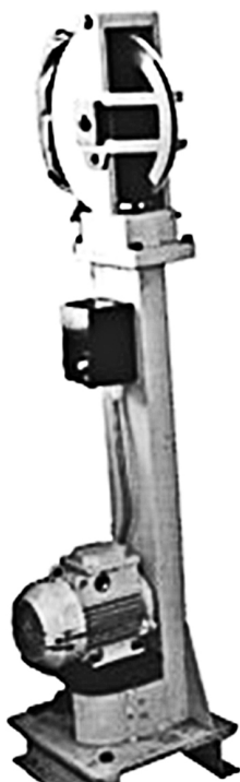
Рис. 8. Дисквая мездрильная машина ЗИМ ДМЗ-30
