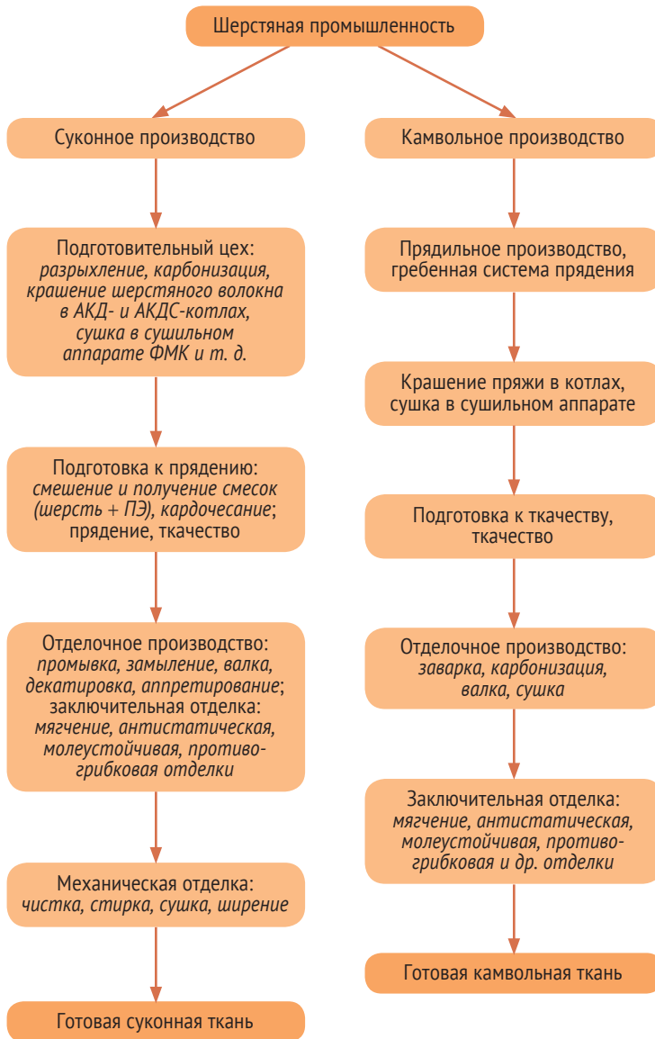
Рис. 14. Примерная технологическая схема камвольного и суконного производства: АКД — аппарат красильный под давлением; АКДС — аппарат красильный под давлением скоростной; ПЭ — полиэфирное волокно
