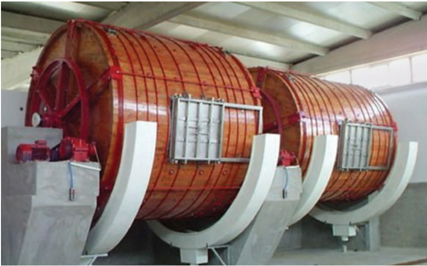
Рис. 4. Барабан для проведения жидкостных обработок кожевенного сырья
