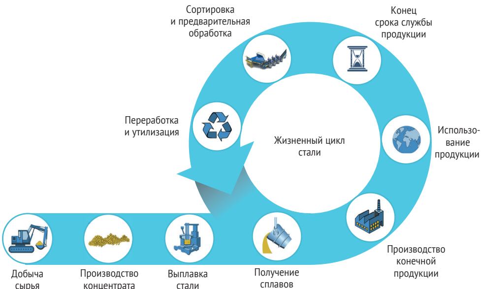
Рис. 6. Жизненный цикл стали
