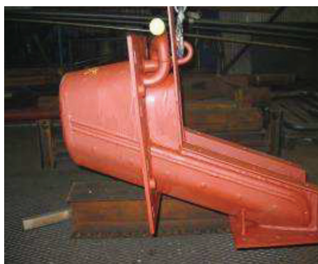
Рис. 33. Вид сбоку летки плава (презентация фирмы Metso)
