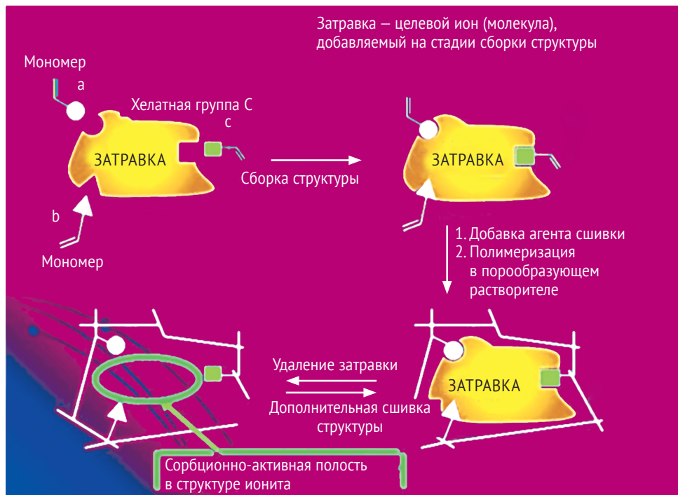
Рис. 89. Блок-схема синтеза ионитов молекулярного распознавания с формированием матричной полости с сорбционно-активными группами (чаще всего хелатного действия). Форма полости в точности повторяет пространственную конфигурацию целевого иона (молекулы)
