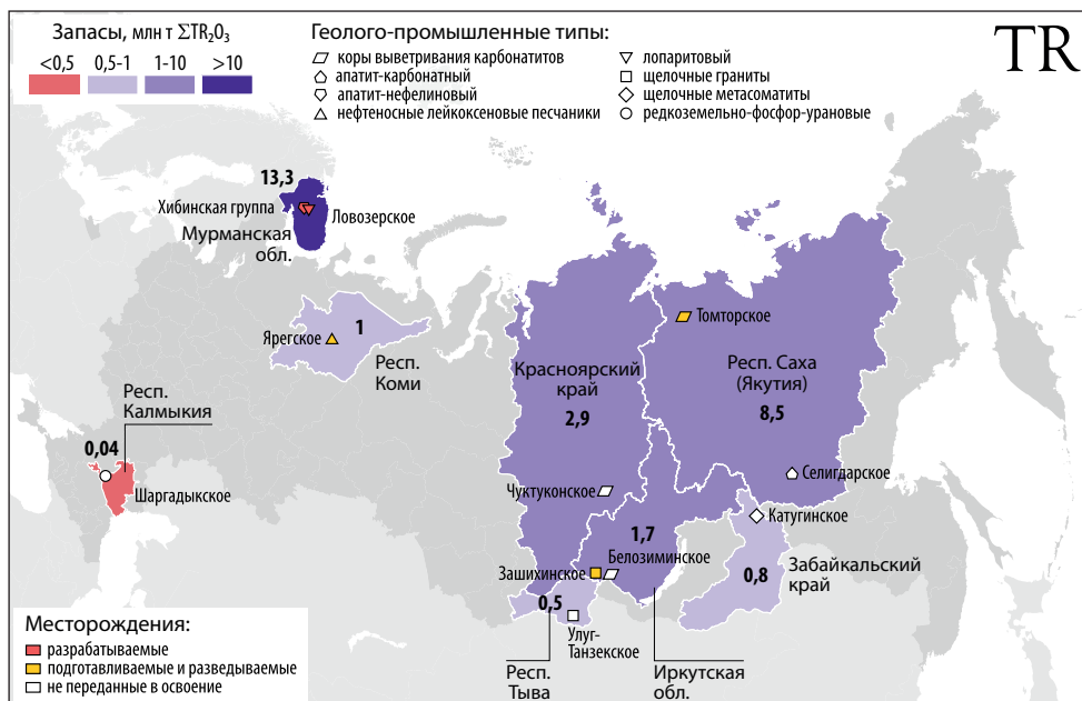
Рис. 28. Распределение запасов РЗЭ между субъектами Российской Федерации, млн т \Sigma TR_2O_3 , и их основные месторождения.
